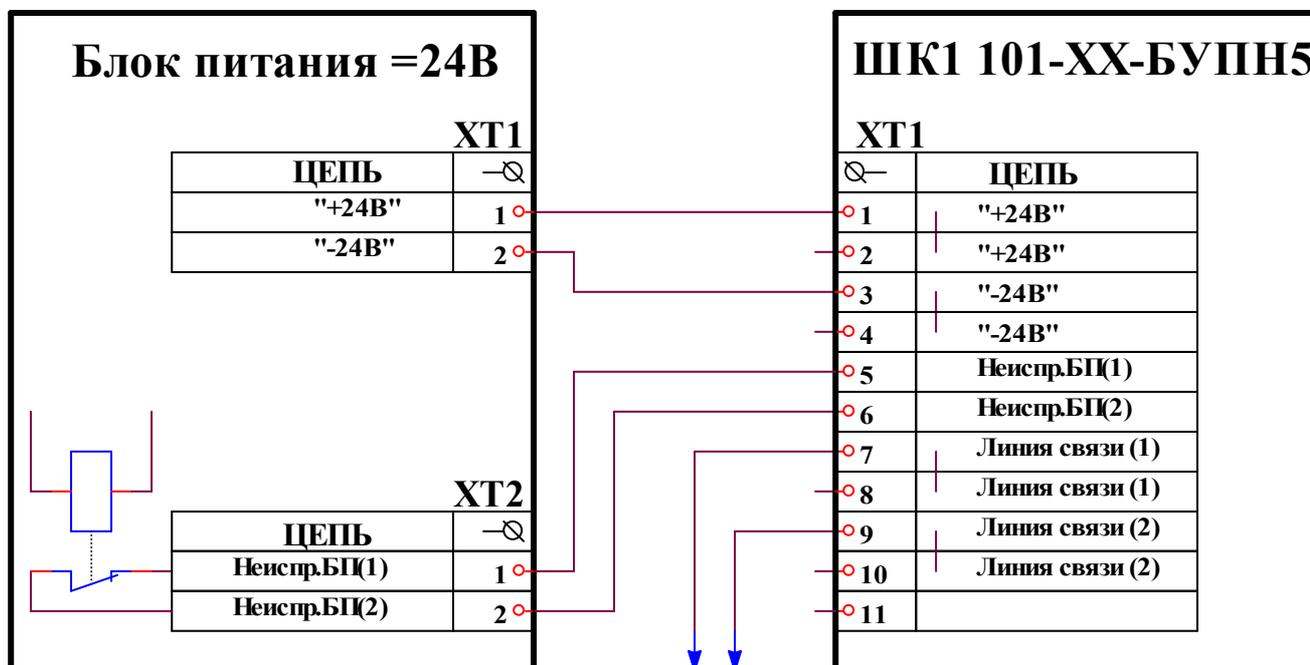
Если внешний источник питания =24В не формирует извещение "Неисправность", то для избежания передачи на ЦП извещения "Неисправность БП" на контакты 5 – 6 разъёма XT1 шкафа ШК1 101-XX-БУПН5 необходимо установить перемычку.
